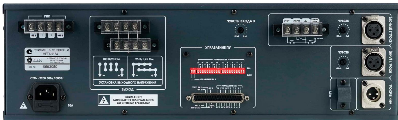
Рисунок 3. Элементы коммутации (клеммы и разъемы) УМ МЕТА 9154.
